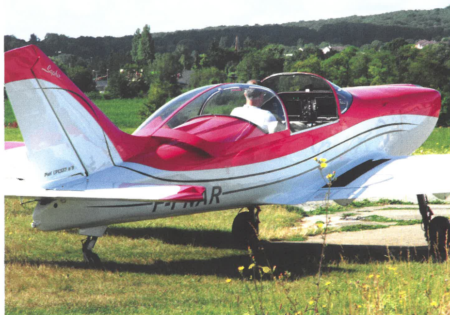
La grande verrière de l'avion est dérivée de celle du Cap 10. Elle se glisse en arrière pour laisser entrer le pilote et ses passagers.
