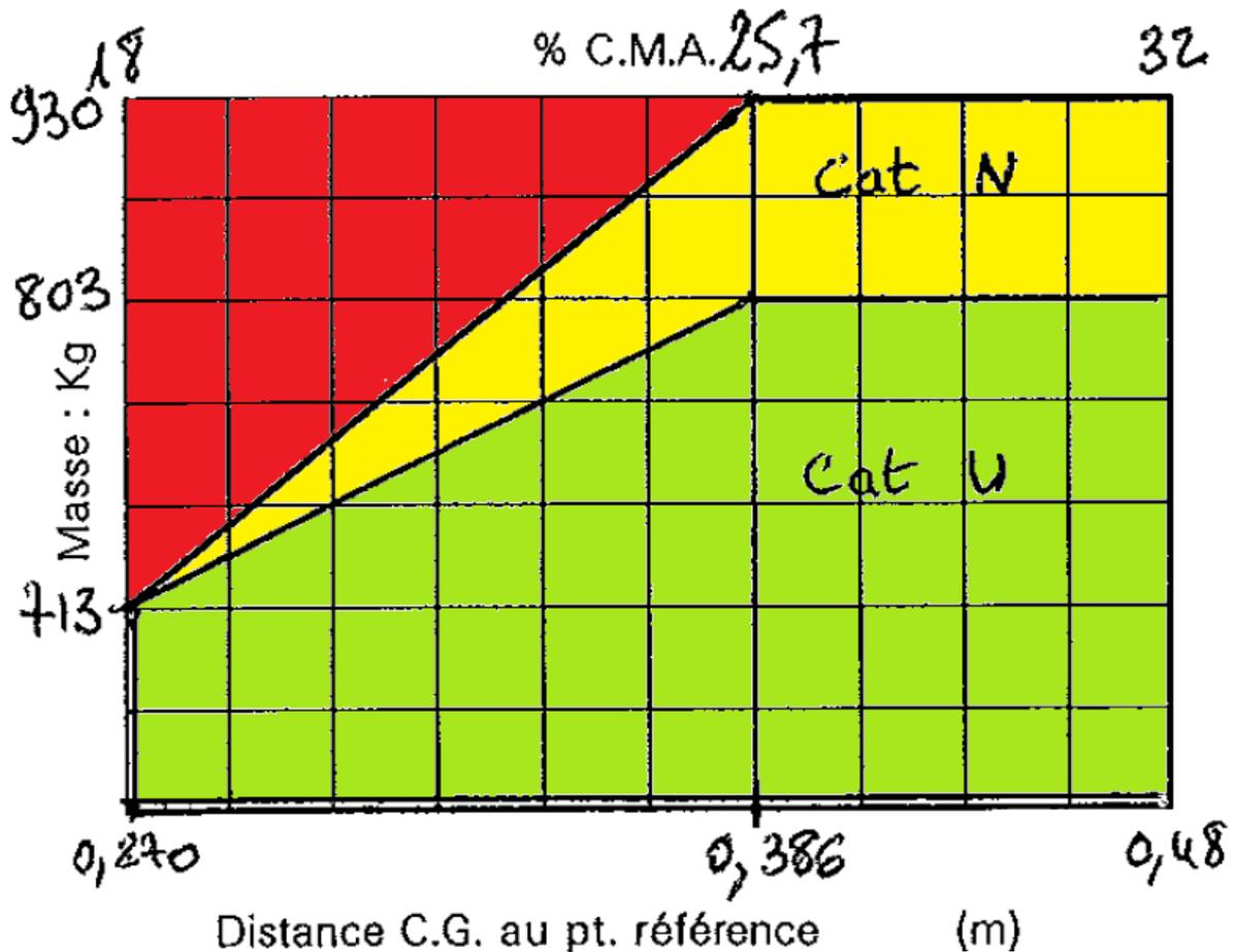
Les « %CMA » (pourcents de Corde Moyenne de l'Aile) de l'échelle supérieure et leur équivalence en mètre de l'échelle inférieure permettent de calculer que la corde moyenne prise en compte vaut 1,50 m.
