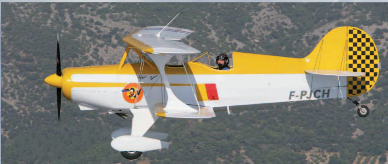
Avion biplace de voltige en tubes et toile, aile en bois, Steen « Skybolt »
